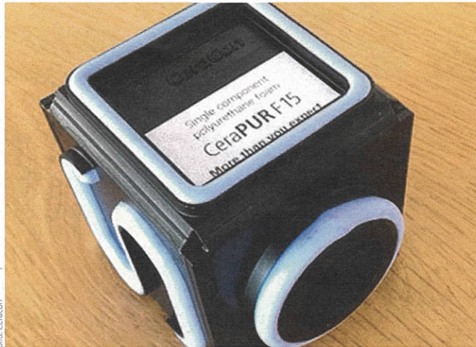
Der Würfel wurde mit dem neu entwickelten PUR-Kunststoff Cerapur beschäumt, der sehr reißfest sein soll.
