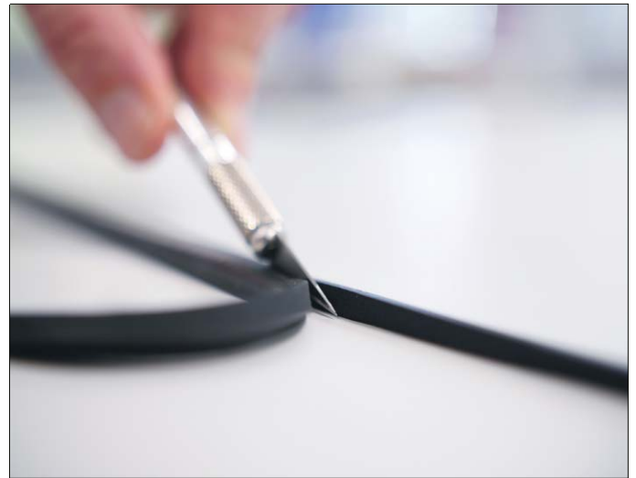
Bild 3: Die Schaumraupe hält dicht, auch wenn die Oberfläche zerstört wurde.
