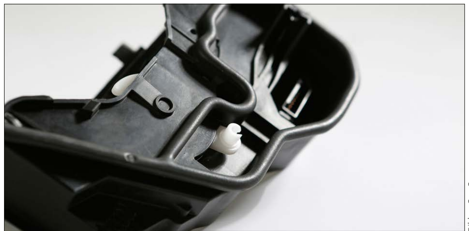
Bild 1: : Türschlösser müssen gegen Feuchtigkeit, Staub und Schmutz abgedichtet werden – sehr gute Dichteigenschaften weist hier der CeraPUR-Schaum auf.
