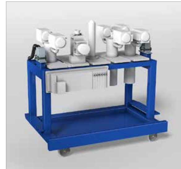
Sistema de preparación y dosificación del material sobre un soporte con ruedas
