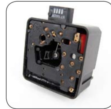
Gelieren von Vergussmassen für Xenon-Scheinwerfersockel
