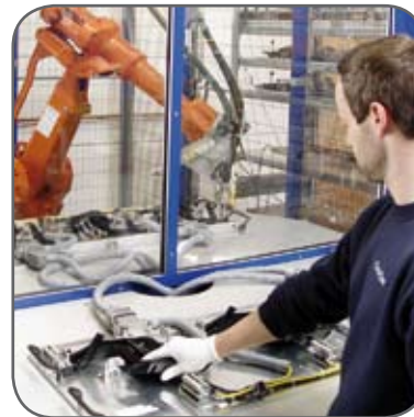
Beschäumen von Lampenträgern an einer automatisierten Roboterzelle
