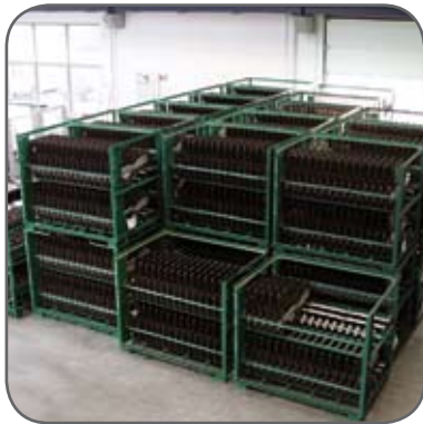
Lagergestelle mit zu beschäumenden Türmodulträgern
