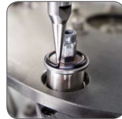
Automatisiertes Beschäumen von Ge- windebuchsen im 3-Sekunden-Takt
